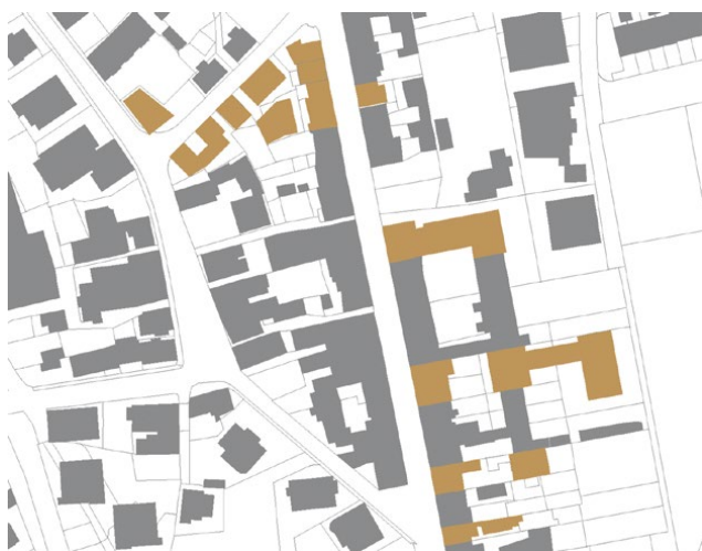
Lageplan Altstadt, farbige Kennzeichnung revitalisierter und neu errichteter Gebäude. Quelle: bernardo bader architekten
