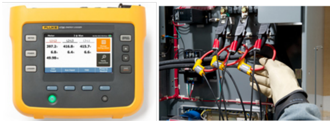
Abbildung 79: Fluke 1730 Three-Phase Energy Logger mit Stromschlaufen
