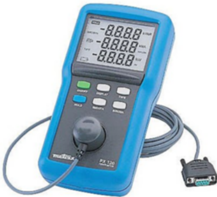
Abbildung 78: Digitales Wattmeter für Wirk-, Schein- und Blindleistung
