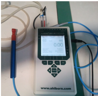
Abbildung 18: Flügelradanemometer mit Multifunktionsmessgerät der Firma Ahlborn
